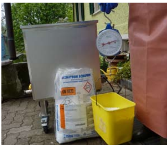
Das Ätznatron sorgfältig abwägen, Pulver nicht einatmen, Hautkontakt vermeiden.
