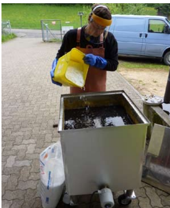
Bei der Herstellung der Lauge zuerst das kalte Wasser in die Chromstahlwanne füllen. Anschliessend das abgewogene Ätznatron vorsichtig dazugeben.
