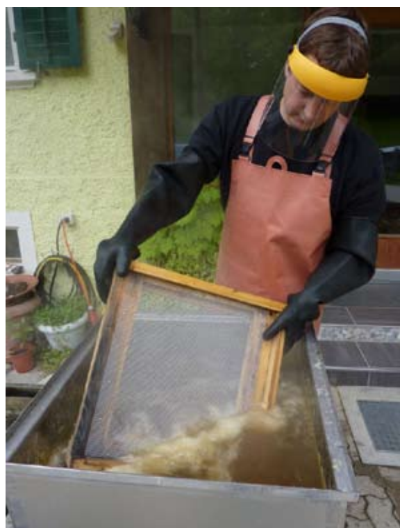
Das Material in die Lauge tauchen, genügt meistens, mit einer groben Bürste kann vorsichtig nachgeholfen werden.
